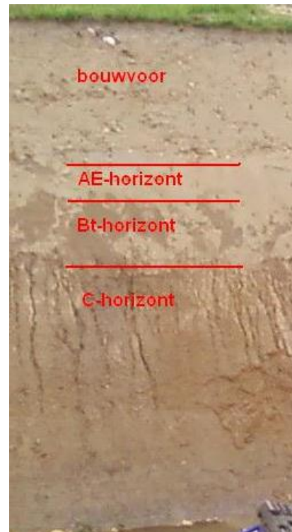
Afb. 4 Profielkolom (correspondeert met boorpunt 22)
