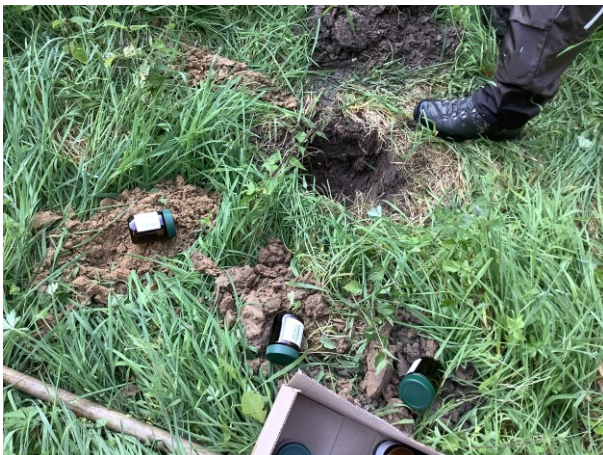
Foto 5 Asbestinspectiegat ter plaatse van boring 4
