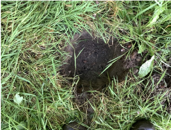
Foto 1 Asbestinspectiegat ter plaatse van boring 1
