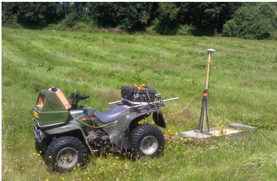
Figuur 1: meetopstelling met 300 MHz grondradar in combinatie met RTK-GPS achter de quad aan de Puddelerweg te Landgraaf.
