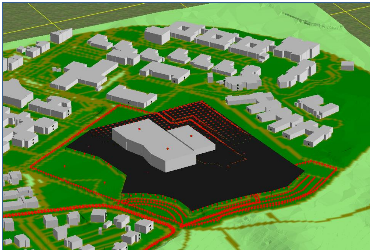
Afbeelding 3. Rekenmodel, 3d-weergave (met oppervlaktebronnen)
