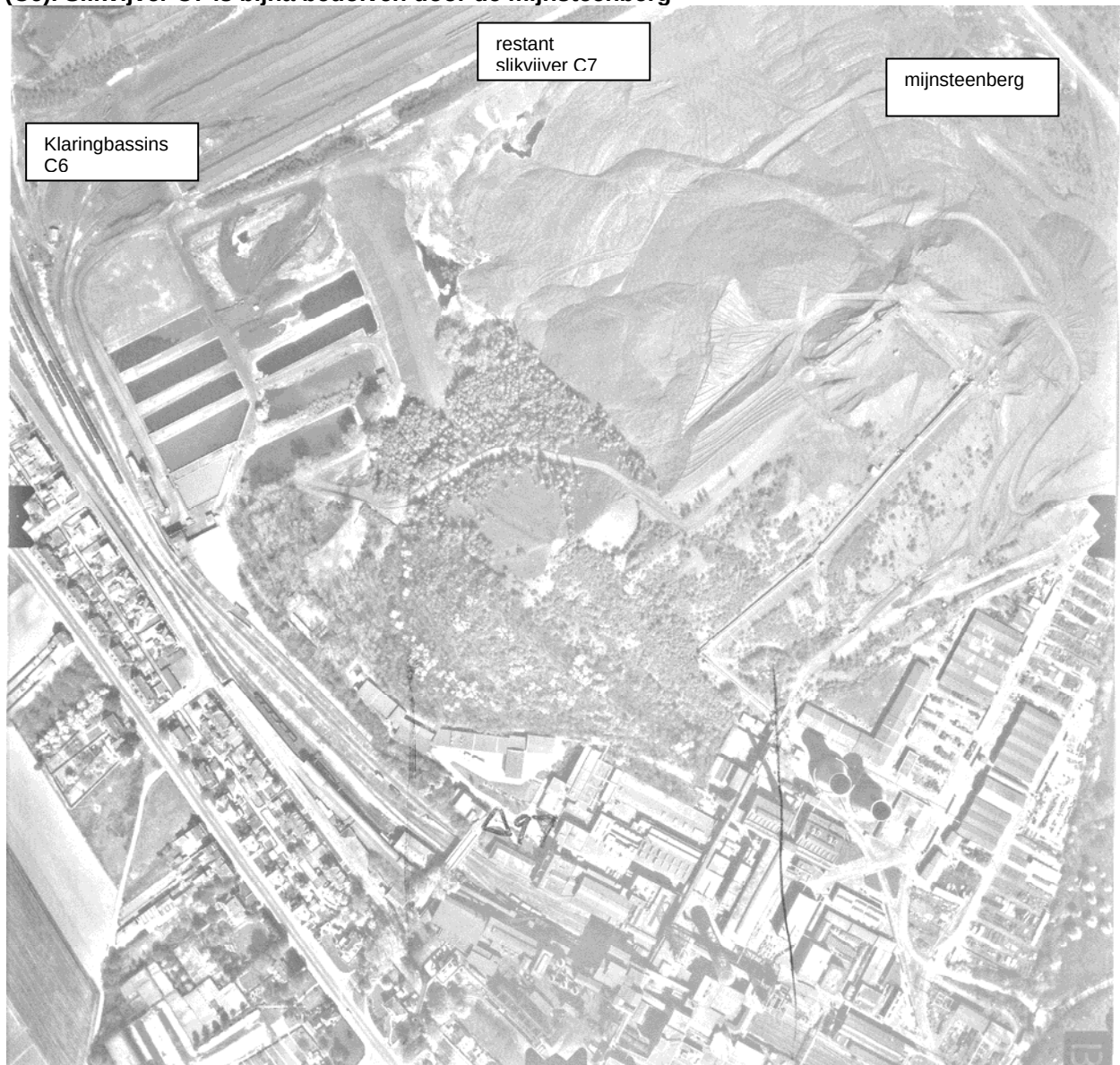
Foto 12: steenkoolmijn Wilhelmina, duidelijk zichtbaar de mijnsteenber (C6). Slikvijver C7 is bijna bedolven door de mijnsteenber
