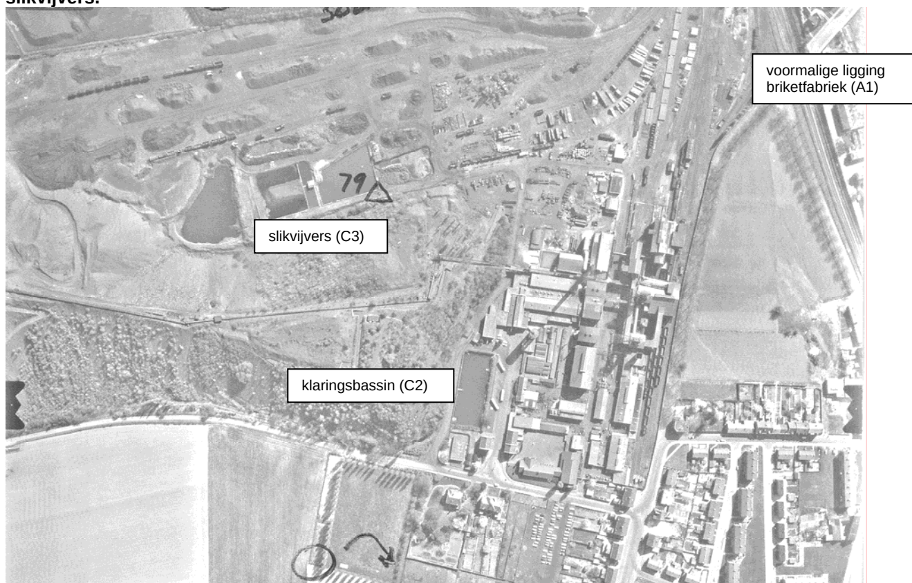
Foto 6: bovengrondsbedrijf steenkoolmijn Oranje-Nassau II. Duidelijk zichtbaar is het klaringsbassin (C2) en de slikvijvers (C3) en het rangeer- en opslagterrein ten noorden van de slikvijvers.
