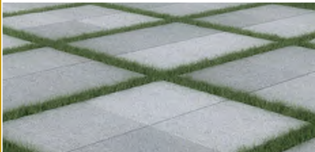
3. betontegels 50x50 4 aaneengesloten, brede grasvoegen
