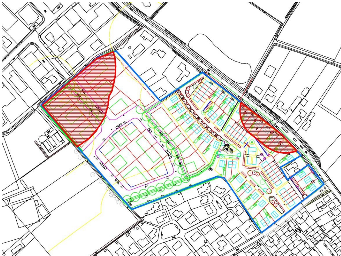
Figuur 3.3 Overlap van indicatieve milieucouturen (VNG) van bedrijven rondom het plangebied. Contouren op basis van werkelijke bedrijfsactiviteiten. De contouren behorende bij de sportvelden zijn niet in deze figuur opgenomen.
