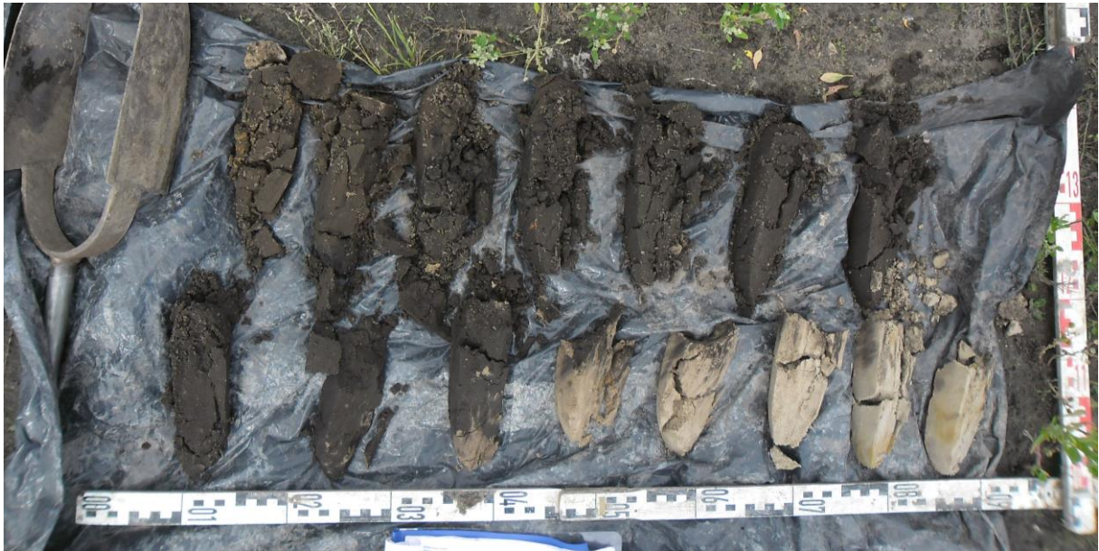
Opname van boring 13. De rommelige overgang tussen het humeuze dek en het gereduceerde pleistocene zand is het gevolg van versterking.
