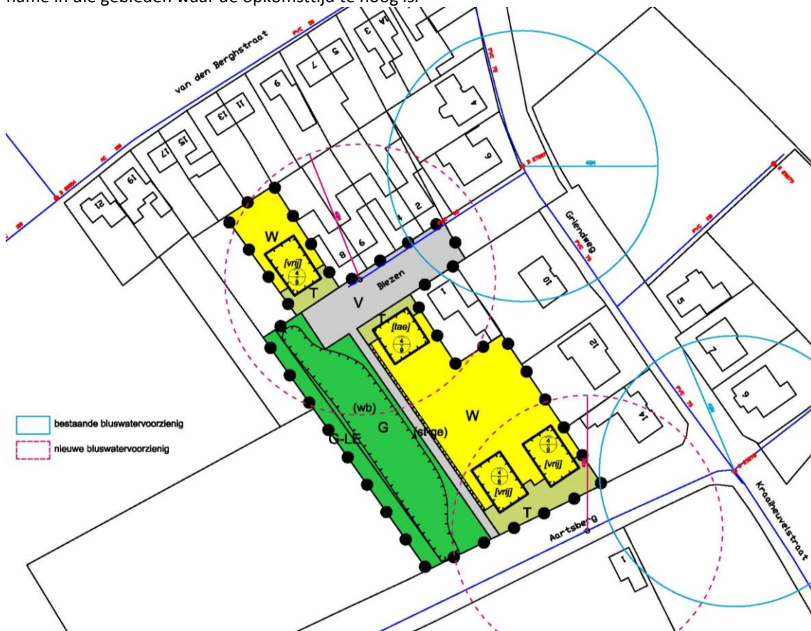
Figuur 21: Overzicht bluswatervoorzieningen
