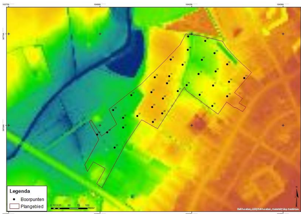
Afbeelding 17. Uitgevoerde boringen met nummering op het AHN (bron: www.ahn.nl ) (betekenis van de kleuren: donkerblauw = circa 6,4 m +NAP; rood = circa 13,4 m +NAP; de groene delen van het plangebied liggen tussen 8,0 en 9,4 m +NAP, de oranje delen tussen 9,6 en 10,2 m +NAP).
