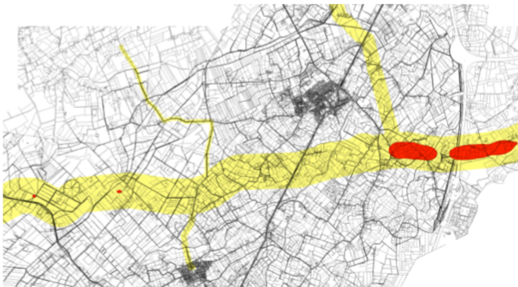
Figuur 18: PR 10^{-6} (rood) van buisleiding A-657. In het geel is het invloedsgebied van de leidingen weergegeven.
