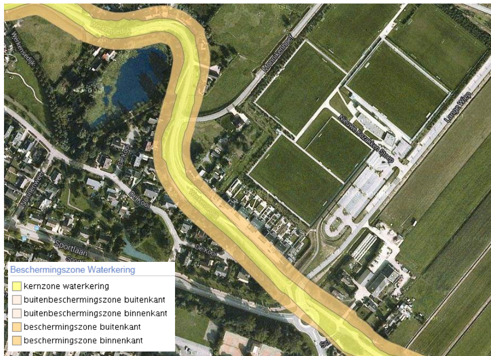
Ligging primaire en regionale waterkeringen, in relatie tot het plangebied (bron: Legger waterkeringen, waterschap Rivierenland)
