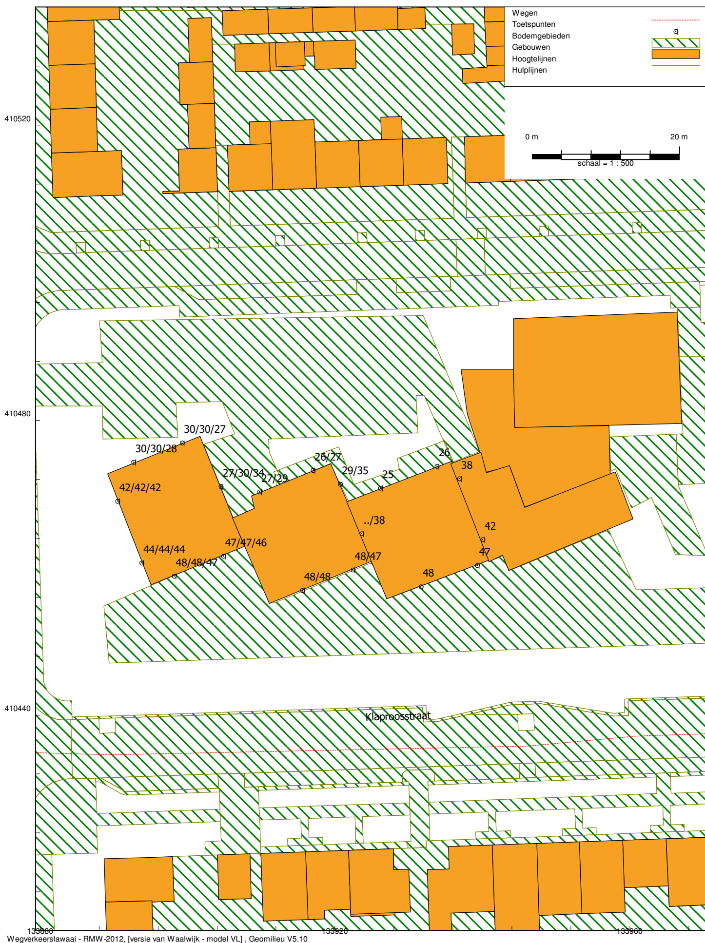
Geluidsbelasting vanwege de Klaproosstraat (30 km/uur) op de 1e/2e/3e woonlaag Waarden in Lden met toepassing van de aftrek van 5 dB van de Wet geluidhinder
