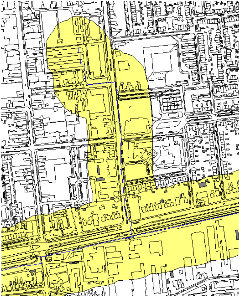
Figuur 10: Invloedsgebied (geel) ter hoogte van Wilhelminastraat. Er is niet langer sprake van een PR 10^{-6} contour
