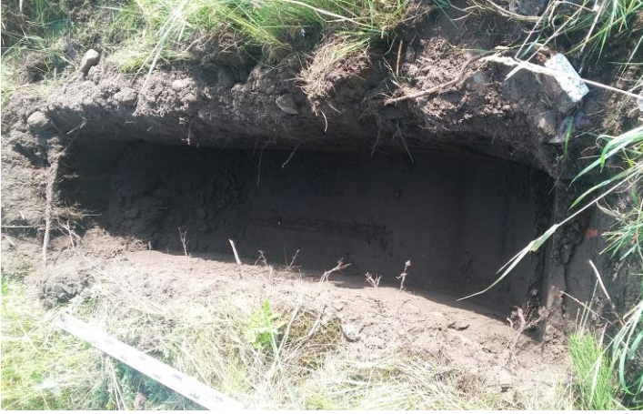
foto 1: bovenaanzicht van een sleuf t.b.v. asbestonderzoek
