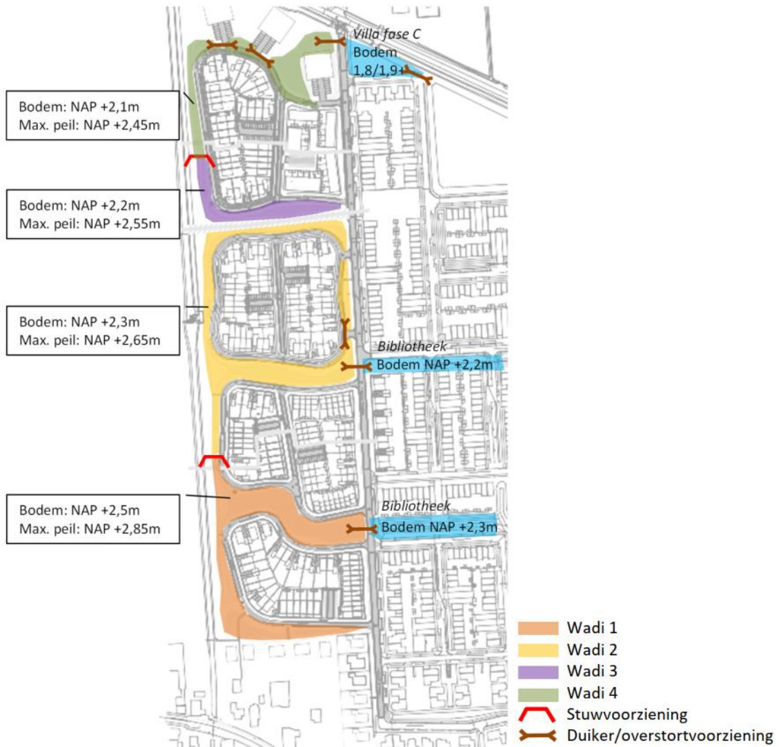
Afbeelding 4.6: Overzicht systeem waterberging plangebied Lommerrijk.
