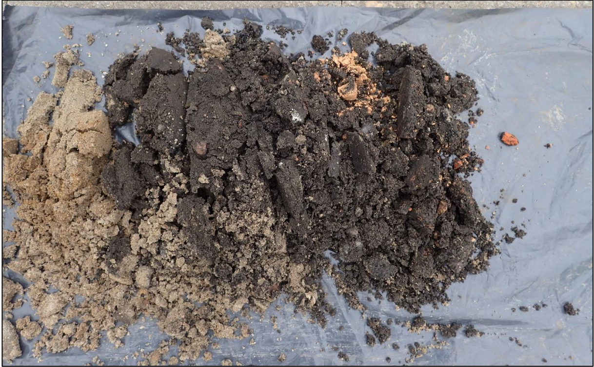
Boring 5: 0-50 cm –Mv. Gestaakt in puin.
