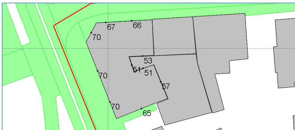
Figuur 2 Hoogst berekende geluidbelasting vanwege de spoorlijn Den Bosch - Eindhoven
