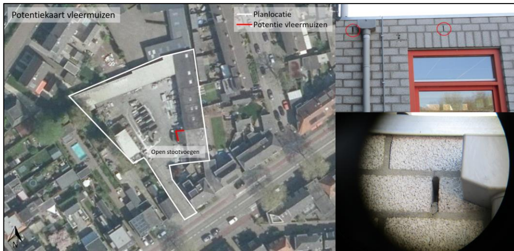
Figuur 4 In het lage gebouw (E) zijn aan de noord- en westzijde zeven open stootvoegen aanwezig welke leiden naar een geschikte rust- en verblijfplaats voor vleermuizen.
