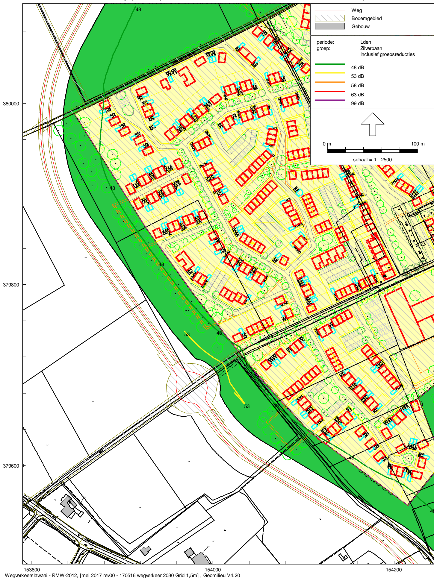
Contouren met referentiewegdek Beoordelingshoogte 1,5 meter (eerste bouwlaag)
