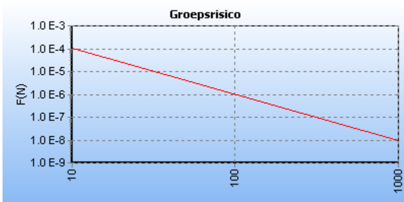
5.5 Figuur 5.5 FN curve voor Z-542-10 Aangepast 1 van N.V. Nederlandse Gasunie voor de kilometer tussen stationing 2670.00 en stationing 3670.00
