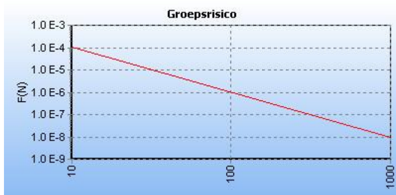
Figuur 5.3 FN curve voor Z-542-02 van N.V. Nederlandse Gasunie voor de kilometer tussen stationing 0.00 en stationing 1000.00
