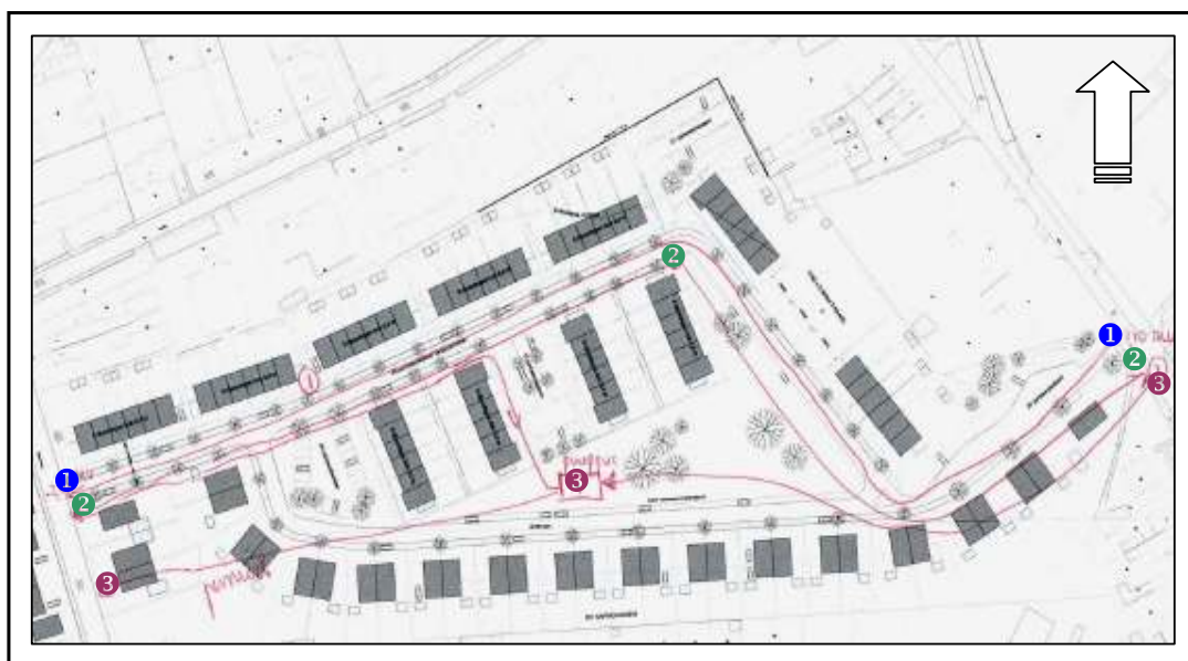
Figuur 1 Aanlegvarianten (principeschets) riolering Dorshout te Veghel
