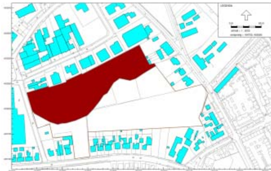
Tekening 6: gebied waarvoor belemmeringen gelden voor het bouwen van woningen op 10.0 mv+ gebaseerd op de maatgevende 45/40/35 dB(A) dag-/avond-/nachtperiode contour per afzonderlijke inrichting
