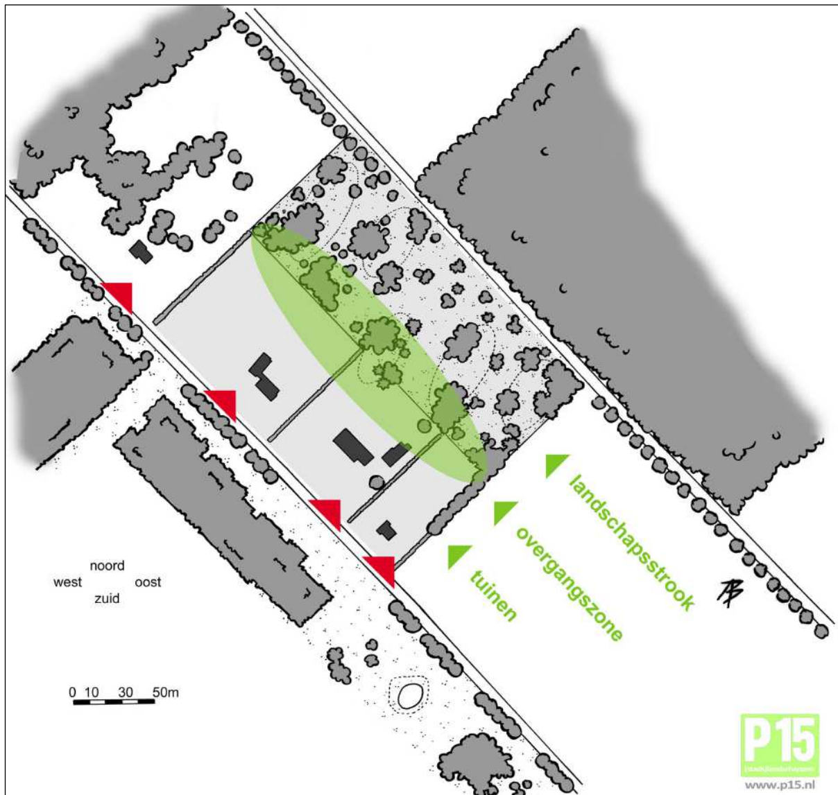
Figuur 8: Ontwerpprincipe in stroken parallel aan de Landerlaan en de grensweg. De overgangszone voorkomt een harde grens tussen tuin en landschapstrook
