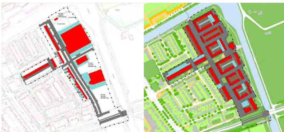
Bestaande (links) en nieuwe afwaterende oppervlakten (rechts)
