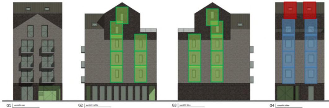
Afbeelding 4.6: Toe te passen 'dove' gevels (rood gearceerd) en cassette type 2 (groen gearceerd). De reeds ontworpen 'dove' gevels zijn blauw gearceerd.)
