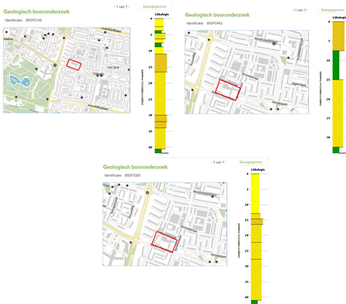
Figuur 3: Archiefgegevens DINOloket | Boringen: B50F0149, B50F0443 en B50F0380
