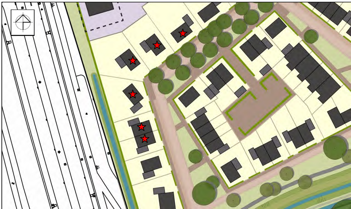
Figuur 2.8: Woningen van plan 'Enschotsebaan' die zijn gelegen binnen de 50 dB(A)-contour van bedrijventerrein 'Loven'
