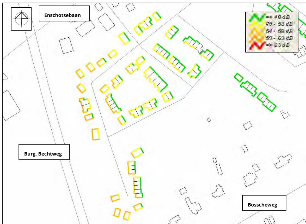
Figuur 4.1: Geluidsbelasting gevels 'Enschtsebaan' t.g.v. de Burgemeester Bechtweg, inclusief correctie art.110g Wgh
