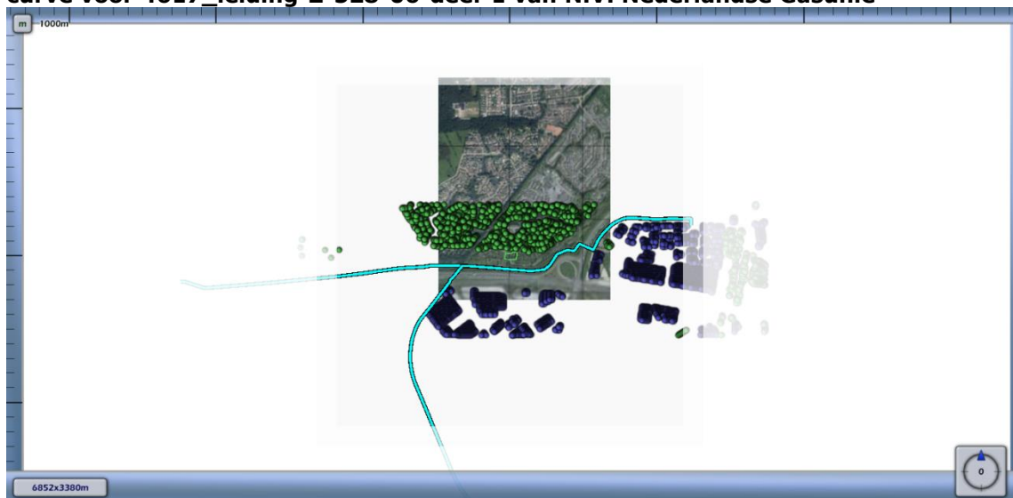
Figuur 4.3 Kilometer leiding behorende bij de maximale overschrijding van de FN-curve voor 4617_leiding-Z-528-06-deel-1 van N.V. Nederlandse Gasunie
