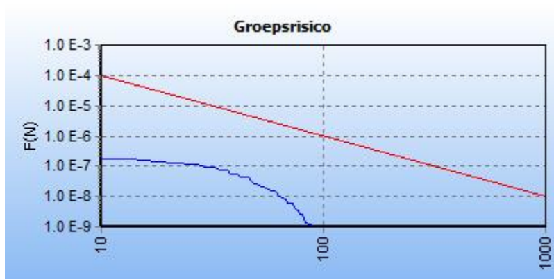
Figuur 2.6: fN-curve buisleiding Z-528-03-deel-1 ná planrealisatie
