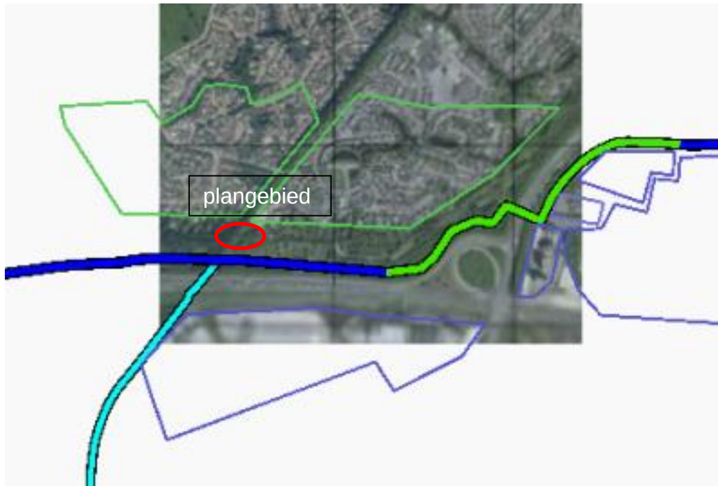
Figuur 2.3: Kilometer leiding met hoogste overschrijdingsfactor (in groen weergegeven) vóór planrealisatie
