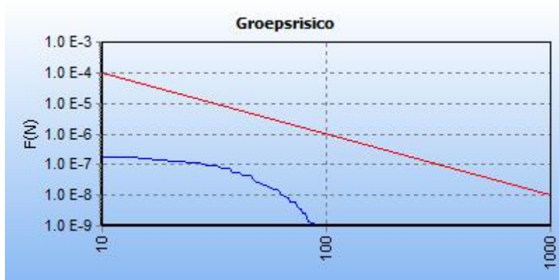
Figuur 2.5: fN-curve buisleiding Z-528-03-deel-1 vóór planrealisatie
