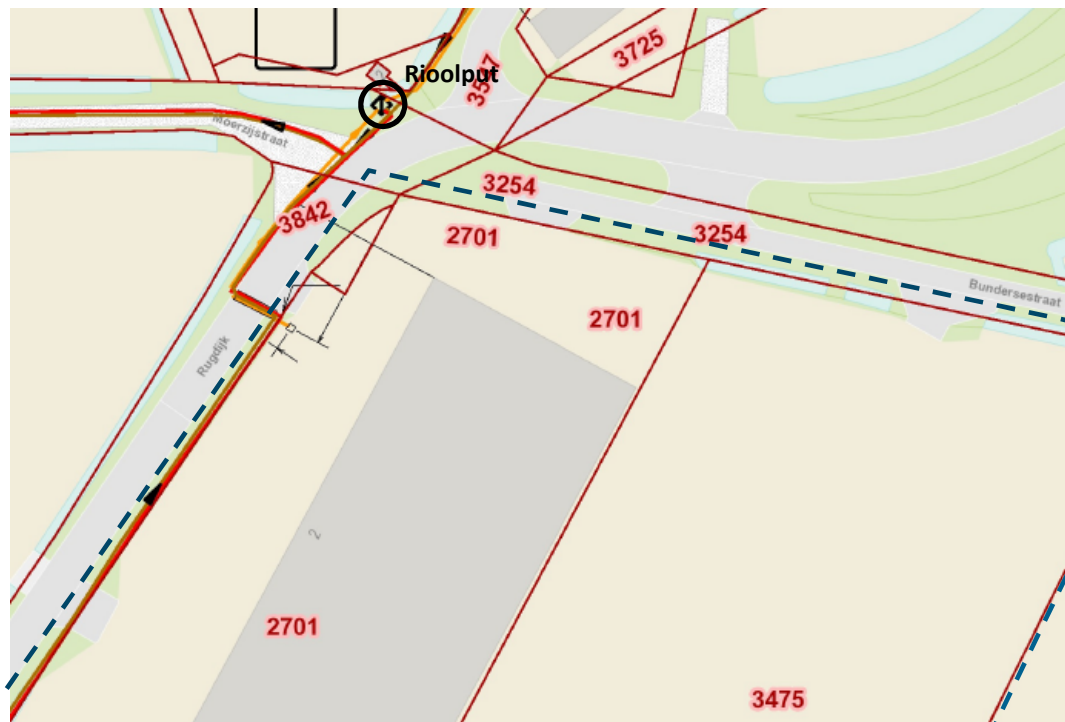
Figuur 2-6: Uitsnede van de situatie van de vuil- en hemelwaterriolering rondom het plangebied (blauw), met in het oranje de drukriolering voor het vuilwater en in het rood de voedingskabel (bron: gemeente Tilburg).
