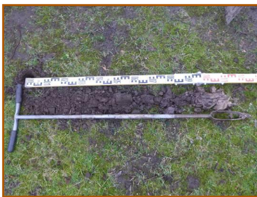
Afbeelding 12. Grondboring in gazon nabij beuk 87
