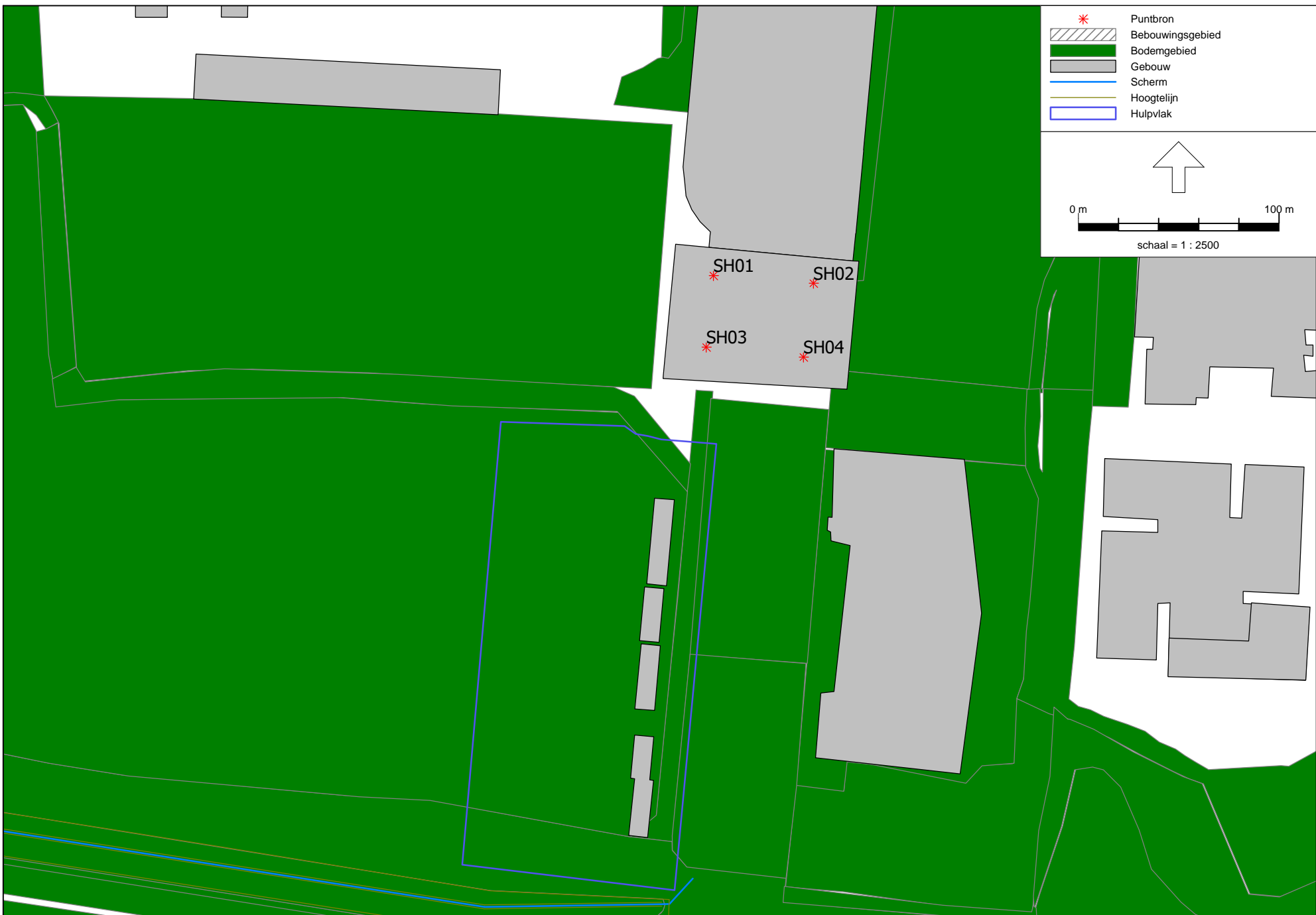
Figuur III-4 Overzicht rekenmodel industrielawaai: bronnen sporthal T-kwadraat
