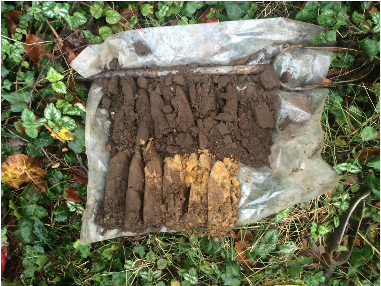
Opname van boring 6
