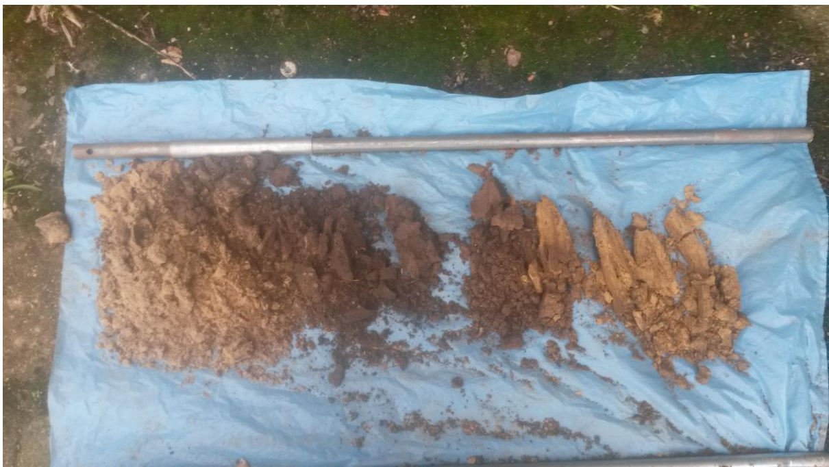
Opname van boring 2. Restant van een humeuze bovengrond op de fluvio-eolische afzettingen
