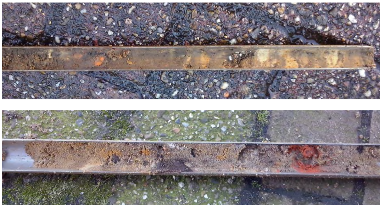
Figuur 17: Foto's van de boringen 3 en 5 met daarin de sterk verstoorde bodemopbouw met tussen de brokken zand van uiteenlopend humusgehalte, brokken oranje-rood baksteenpuin.
