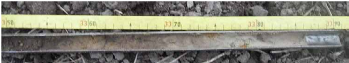
Figuur 9: Foto van boorkern uit boring 57. Hierin is tussen 57 en 70 cm de overgangslaag te zien tussen de sterk humeuze bovengrond en de C-Horizont.
