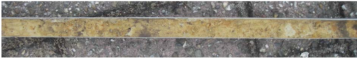
Figuur 17: Foto van boring 2 met daarin het pakket sterk vergraven zand zoals dat in alle boringen is aangetroffen.
