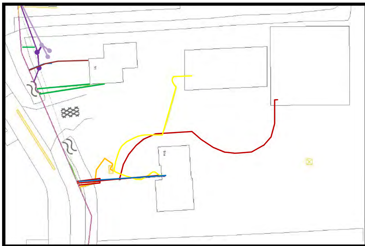
Figuur 8: De aanwezigheid van spanningskabels (rode lijn), waterleidingen (blauwe lijn), gasleiding (gele lijn), datatransportkabels (groene lijn) en riolering (donker- en lichtpaarse lijn) in het zuidwestelijk gedeelte van het deelgebied 't Schouw (bron: KLIC melding).
