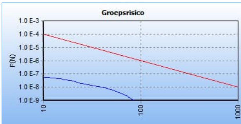
Afbeelding 12 fN-curve buisleiding A-585-deel-1, huidige situatie
