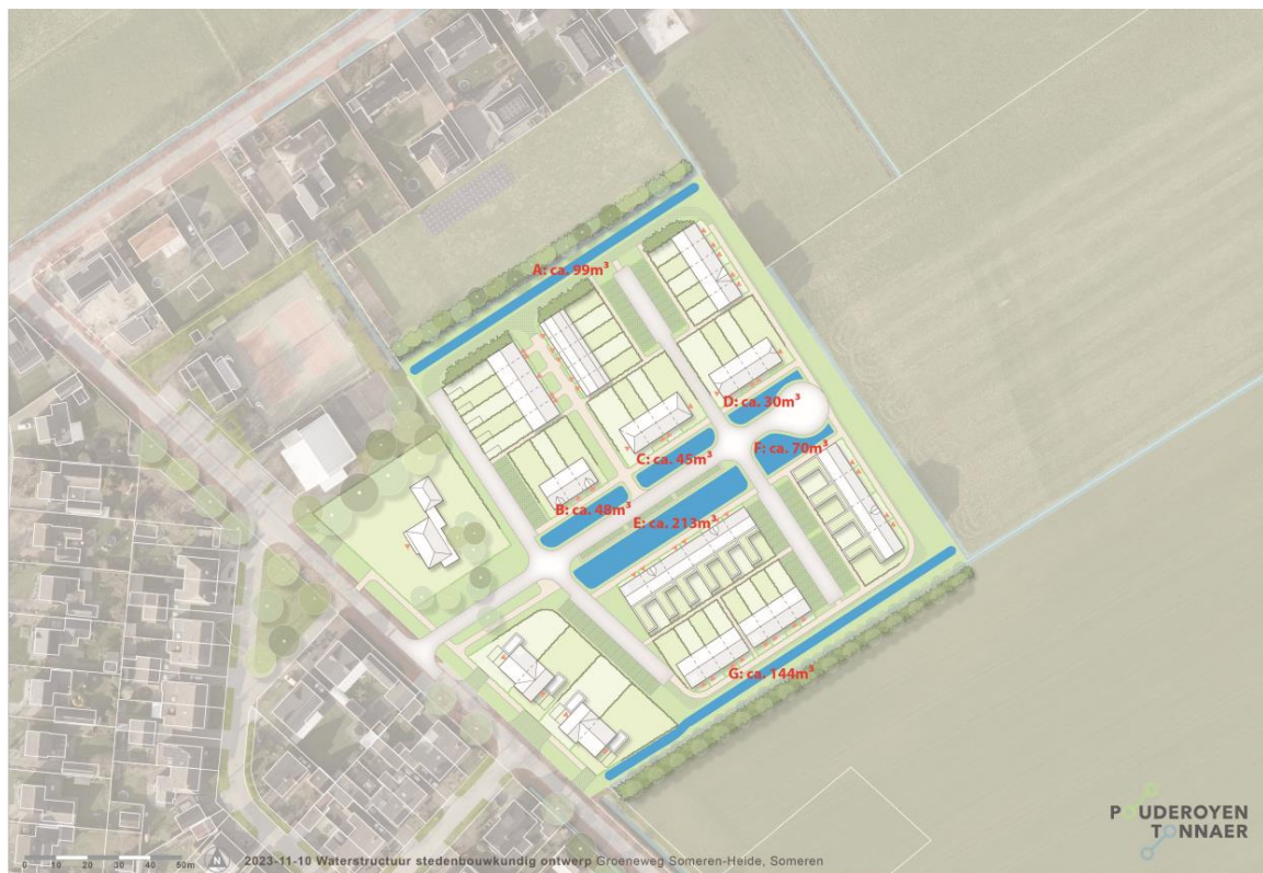
Figuur 10 Schematische situering wadi's inclusief dwarsprofielen en bergingscapaciteit
