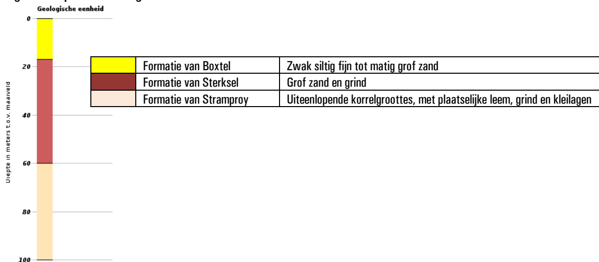
Figuur A: opbouw ondergrond.
