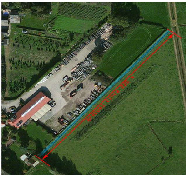
Figuur: infiltratiegreppel t.b.v. hemelwater
