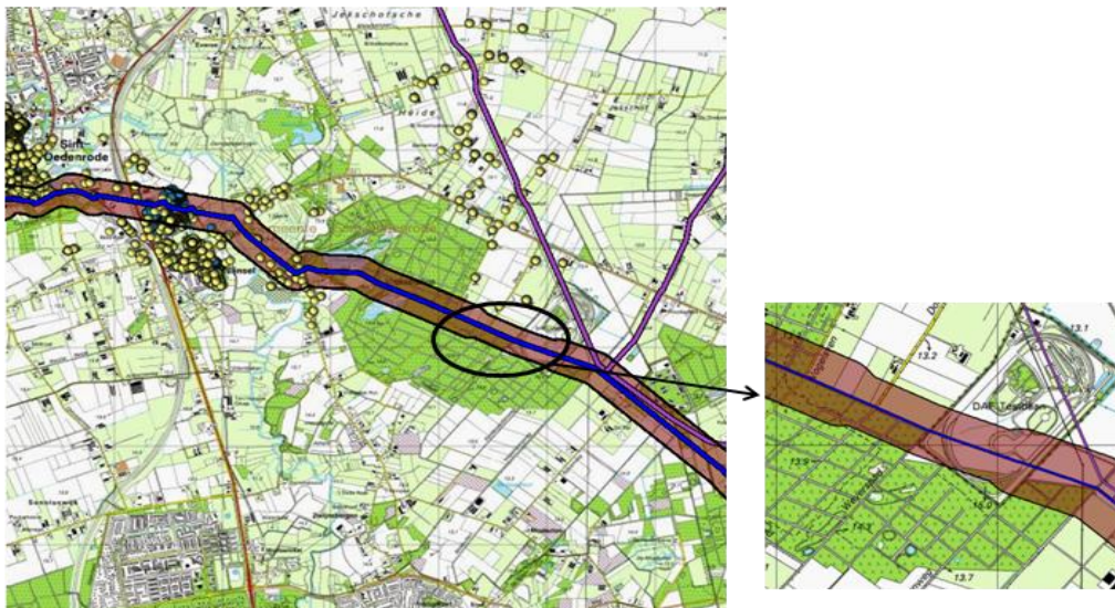
Figuur 15: Ligging leiding en invloedsgebied leiding Z-544-01 (oosten Sint-Oedenrode). De rechterafbeelding geeft de versmalling weer van het invloedsgebied.
