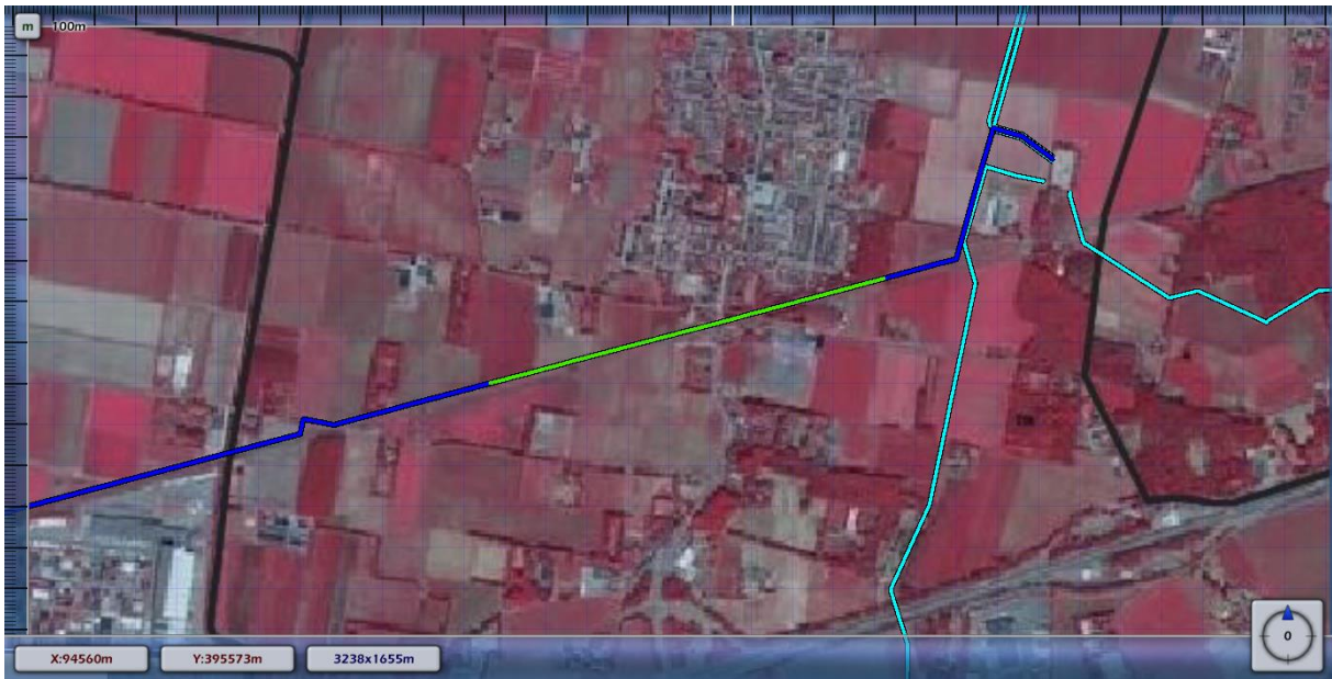
Figuur: Kilometer leiding met het hoogste groepsrisico (groen). In het blauw is de gehele leiding aangegeven.
