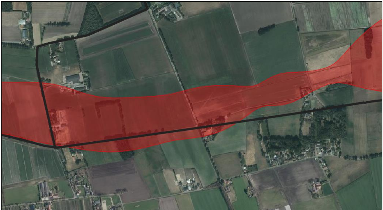
Figuur: Plaatsgebonden risicocontour 10^{-6} per jaar (rood)
