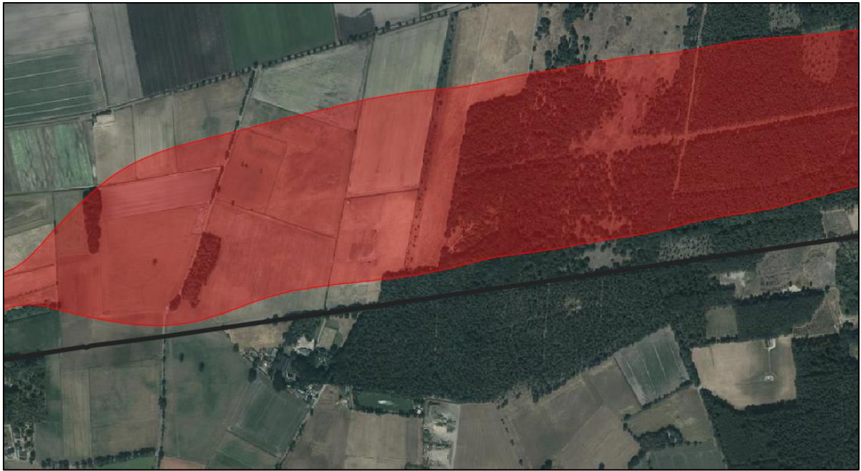
Figuur: Plaatsgebonden risicocontour 10 -6 per jaar (rood)
