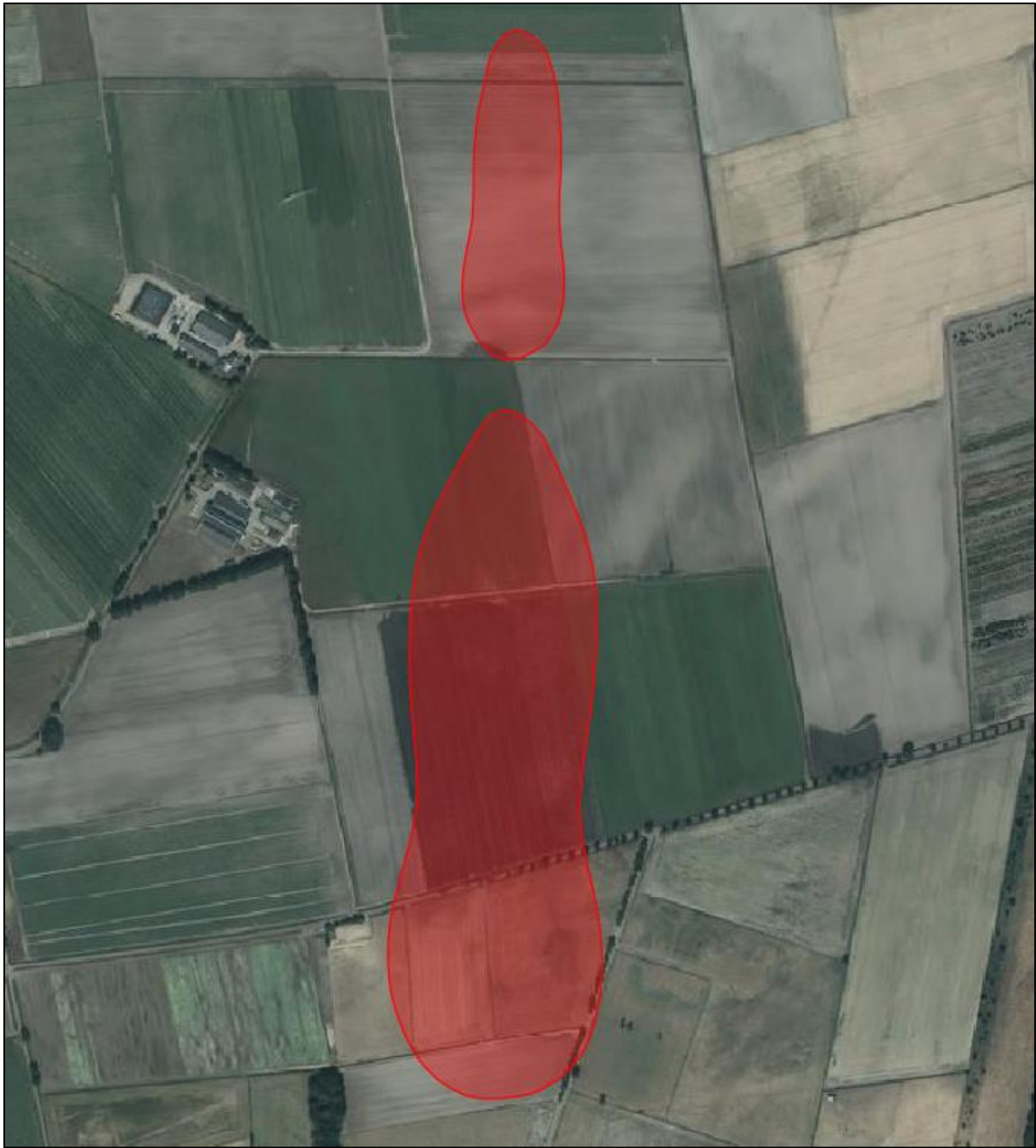
Figuur: Plaatsgebonden risicocontour 10^{-6} per jaar (rood)
