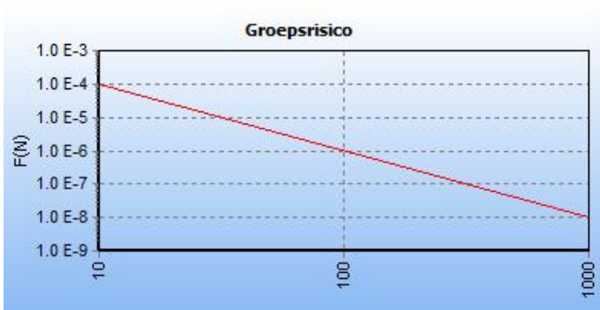
Figuur: FN curve behorend bij de boven aangegeven kilometer leiding.
