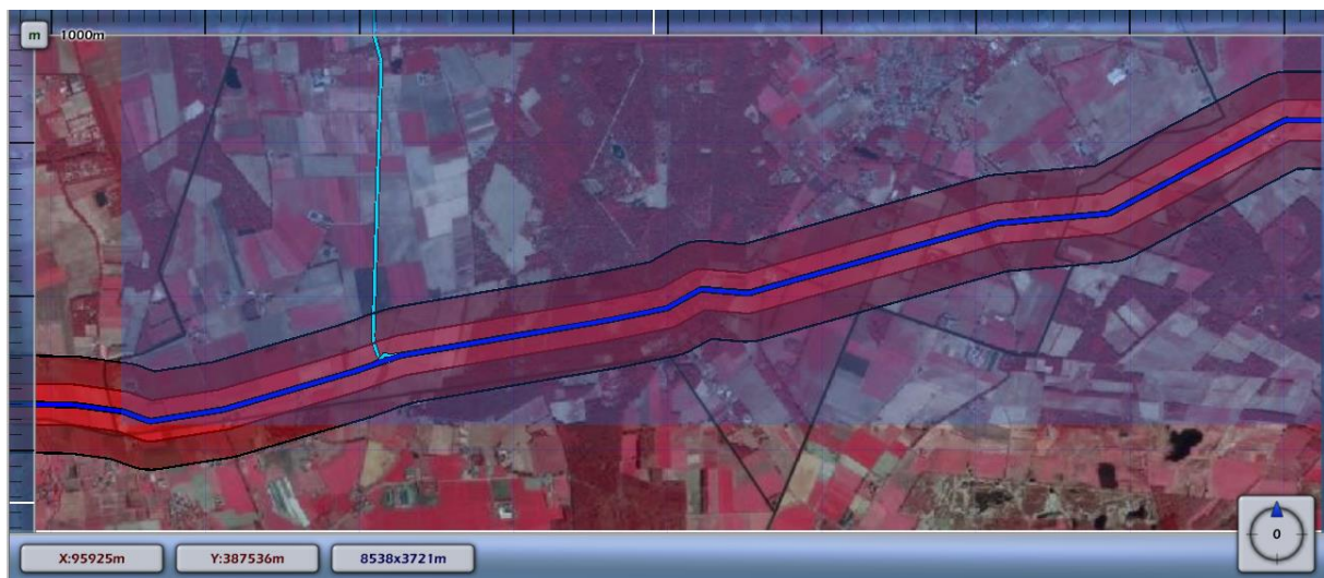
Figuur: Huidige ligging invloedsgebied (1% letaliteit) van de hogedruk aardgasleiding. De binnenste contour is de 100% letaliteitsafstand.
