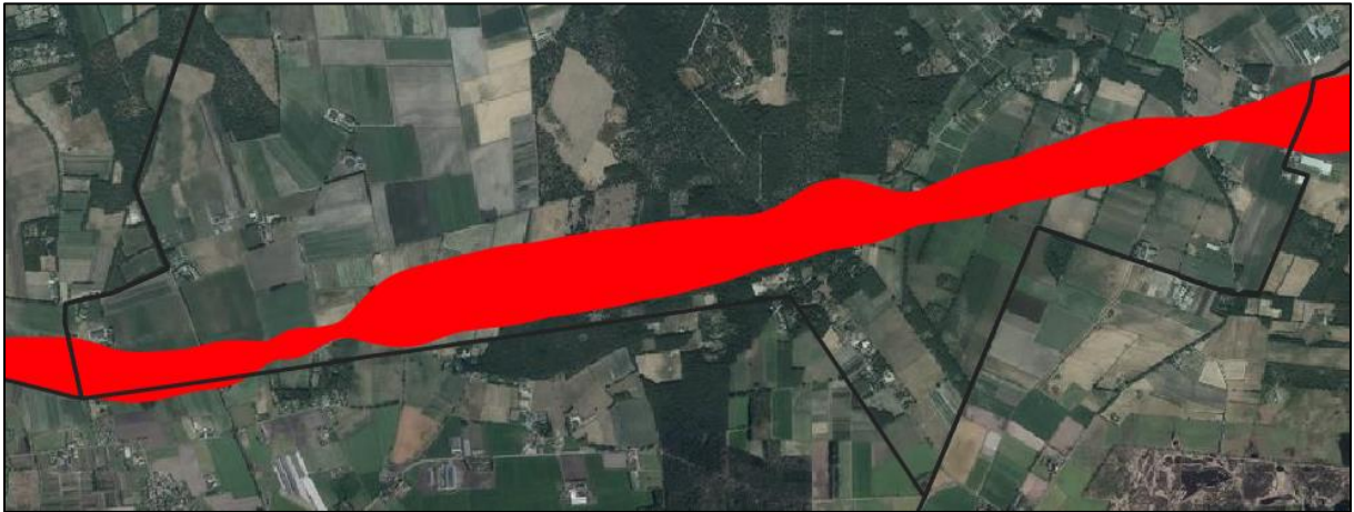
Figuur: Plaatsgebonden risicocontour 10^{-6} per jaar van de gehele leiding (rood)
