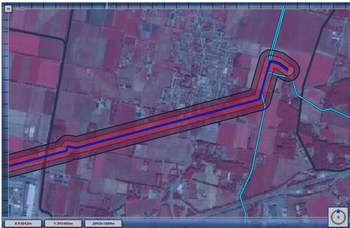
Figuur: Huidige ligging invloedsgebied (1% letaliteit) van de hogedruk aardgasleiding. De binnenste contour is de 100% letaliteitsafstand.
