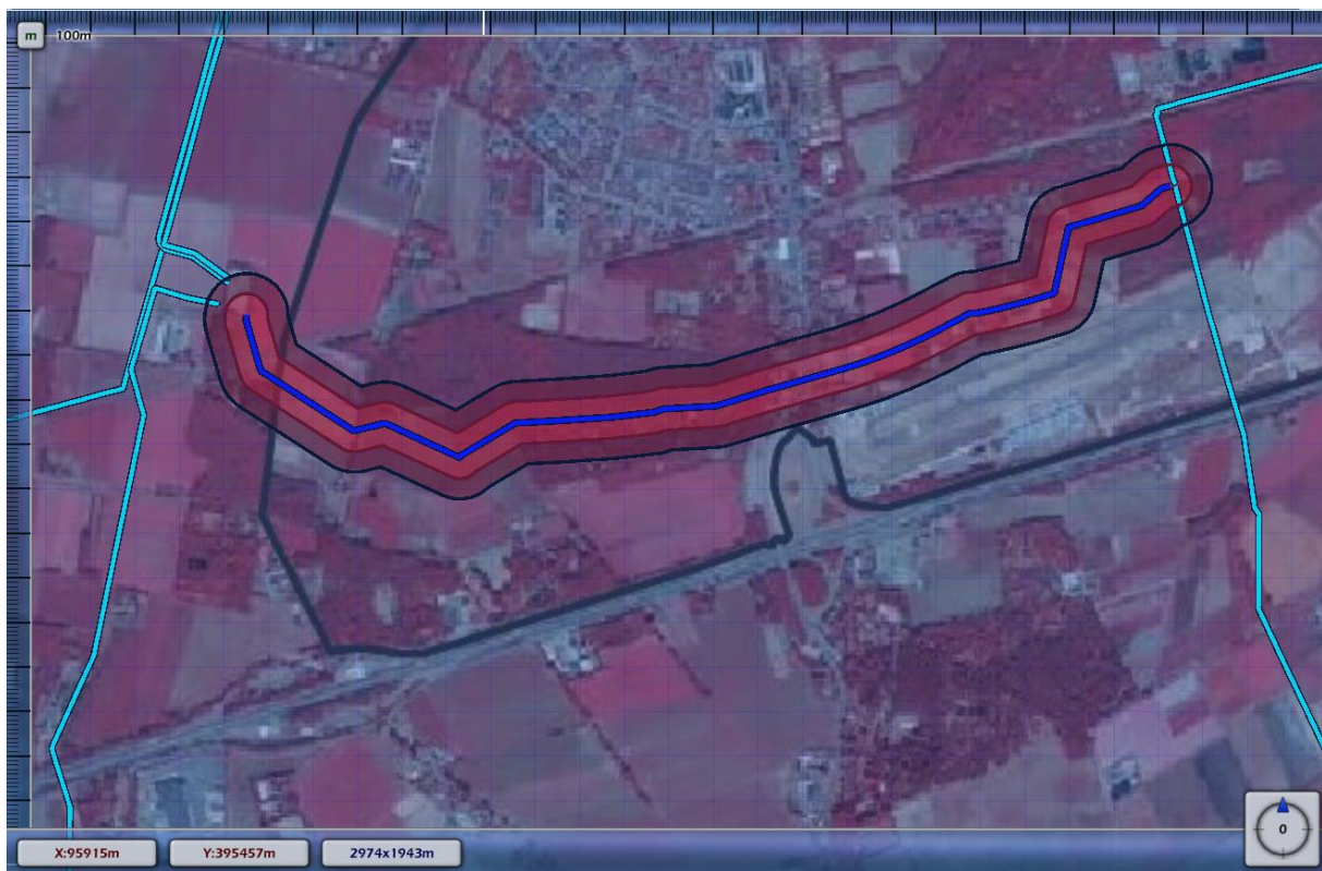
Figuur: Huidige ligging invloedsgebied (1% letaliteit) van de hogedruk aardgasleiding. De binnenste contour is de 100% letaliteitsafstand.
