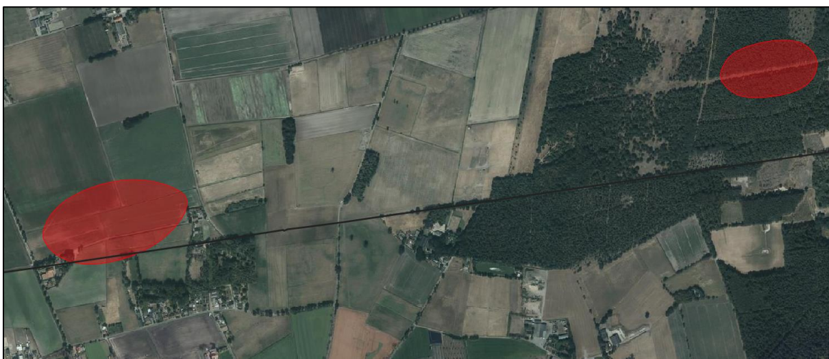
Figuur: Plaatsgebonden risicocontour 10^{-6} per jaar (rood)
