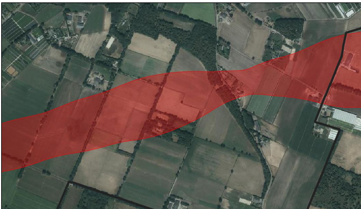
Figuur: Plaatsgebonden risicocontour 10^{-6} per jaar (rood)
