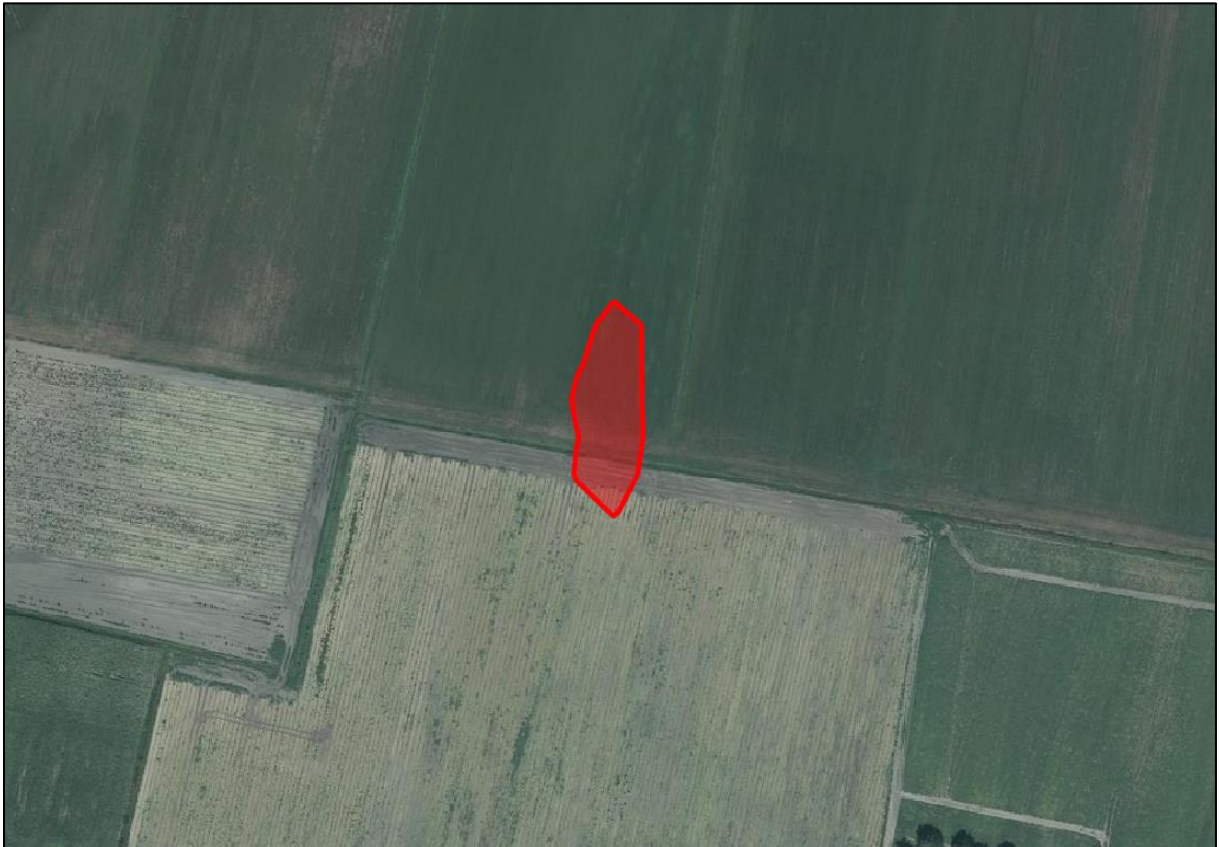
Figuur: Plaatsgebonden risicocontour 10^{-6} per jaar (rood)
