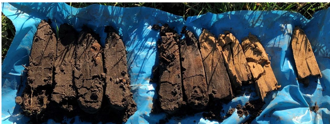
Figuur 2. Foto van boring 1 (Lepage & Rap 2019) waarin te zien is dat onder een circa 35 centimeter dikke bouwvoor een doorgewerkt pakket aanwezig is met brokken van de voormalige E- en B-horizonten. Deze doorgewerkte laag is ook circa 35 centimeter dik. Daaronder bevindt zich de C-horizont.
