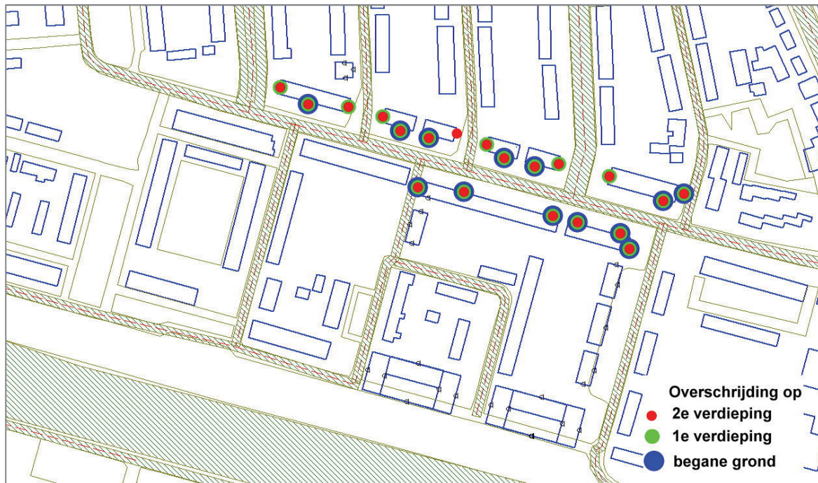
Figuur 4.1 Overschrijdingen als gevolg van de Loevensteinlaan.
