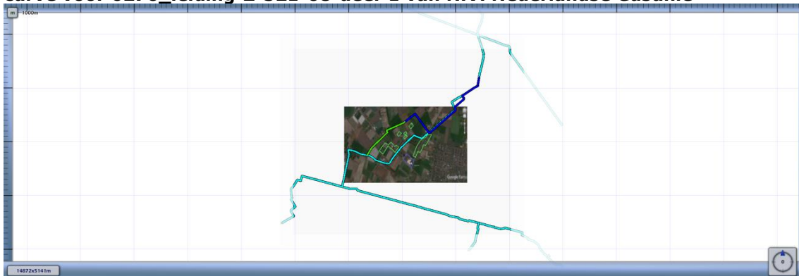
Figuur 4.4 Kilometer leiding behorende bij de maximale overschrijding van de FN-curve voor 6270_leiding-Z-521-08-deel-1 van N.V. Nederlandse Gasunie
