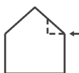
(Zadeldak) met inpandige buitenruimte
