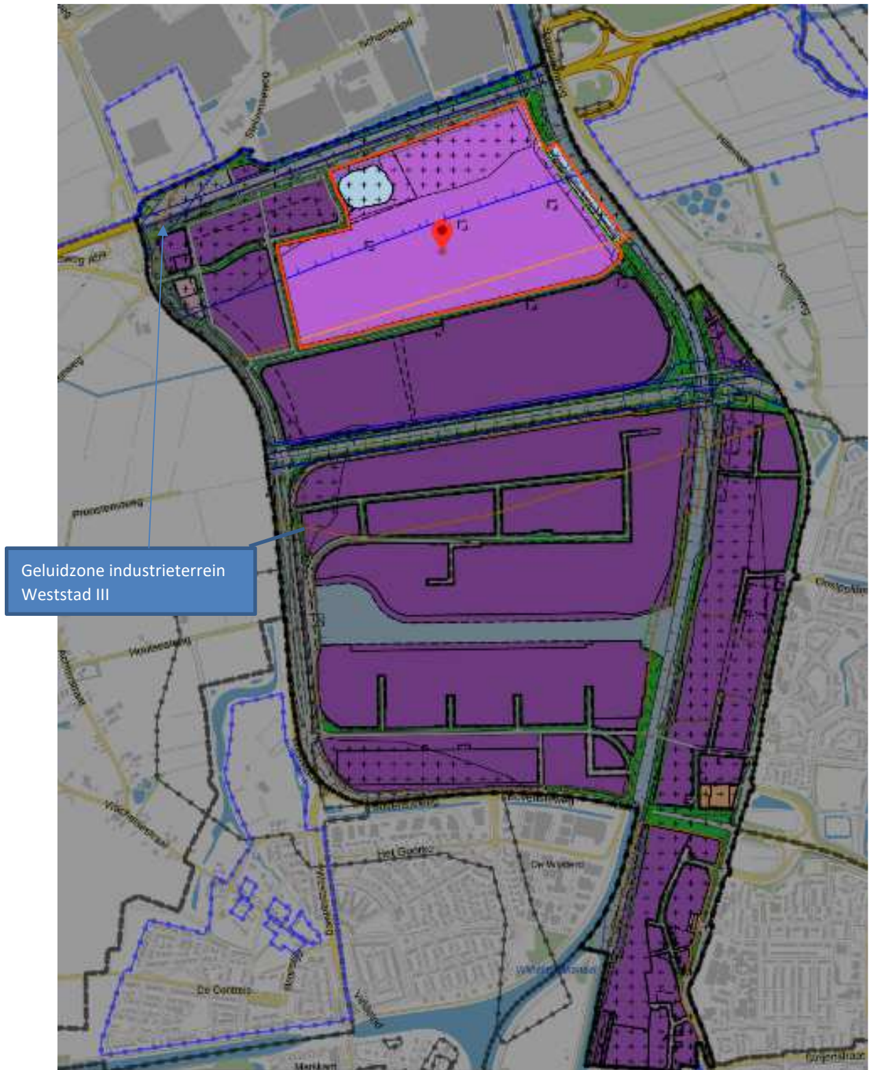
Fig. 7.2a: plangebied, plandeel A, met begrenzing industrieterrein Weststad III (licht paarse gebieden). De bijbehorende geluidzone ligt rondom het industrieterrein. De uiterste grens is aangegeven (oker geel) voor zover gelegen binnen het plangebied.
