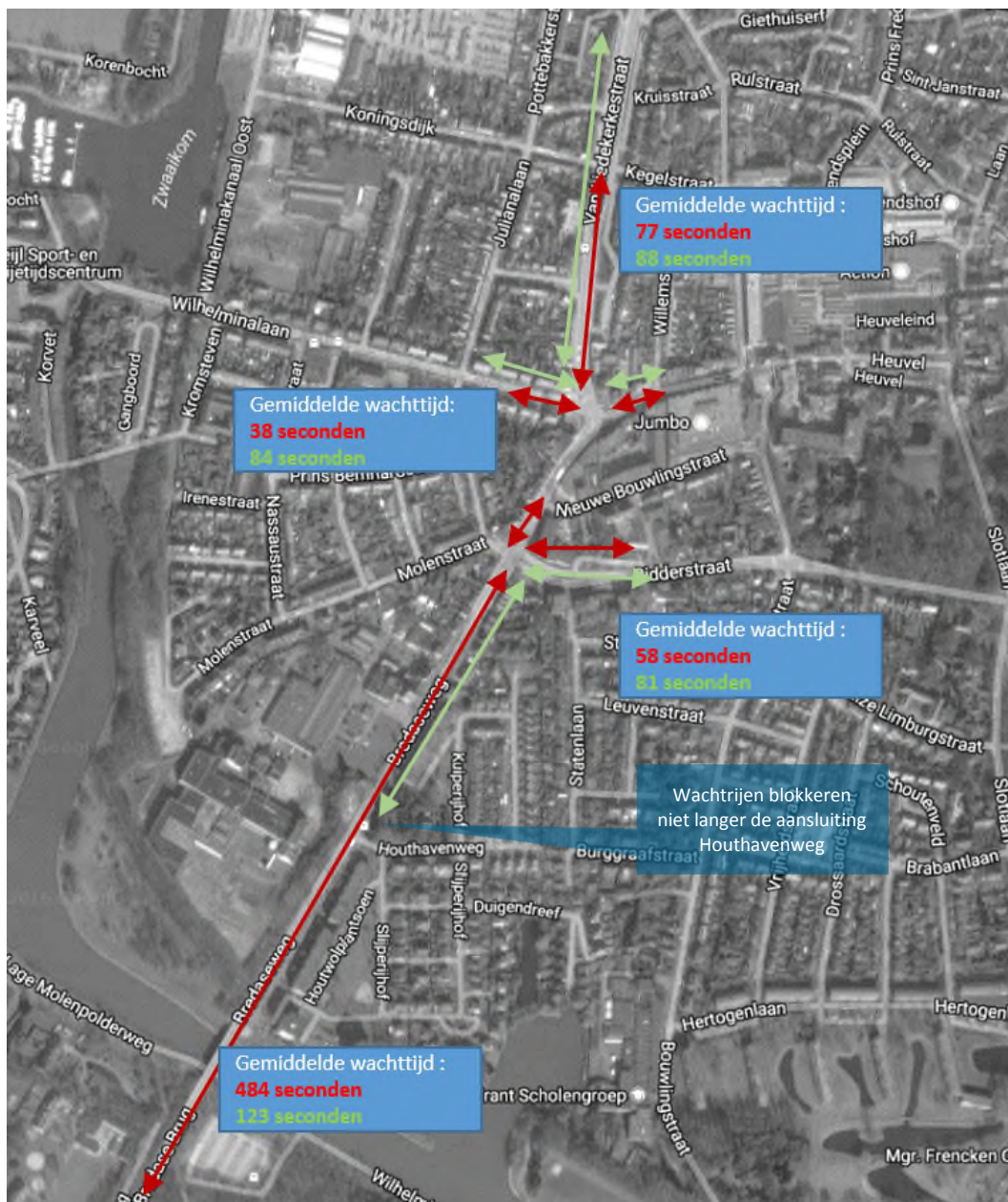
Figuur 11: Maximale wachtrijen en gemiddelde wachttijden op hoofdrichtingen (rood: huidige situatie / groen: plansituatie 2026 met geoptimaliseerde VRI en aangepast woningbouwprogramma Zwaaiikom
